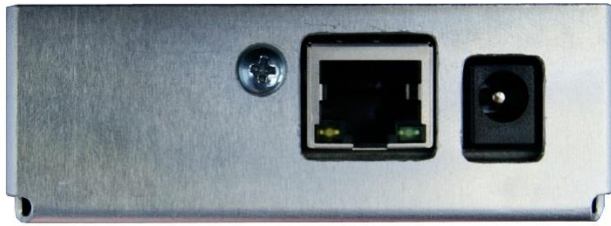
Abbildung 2: Ethernet-Buchse RJ45 und Anschluss Stromversorgung Rundstecker ø 5,5/2,5 mm
