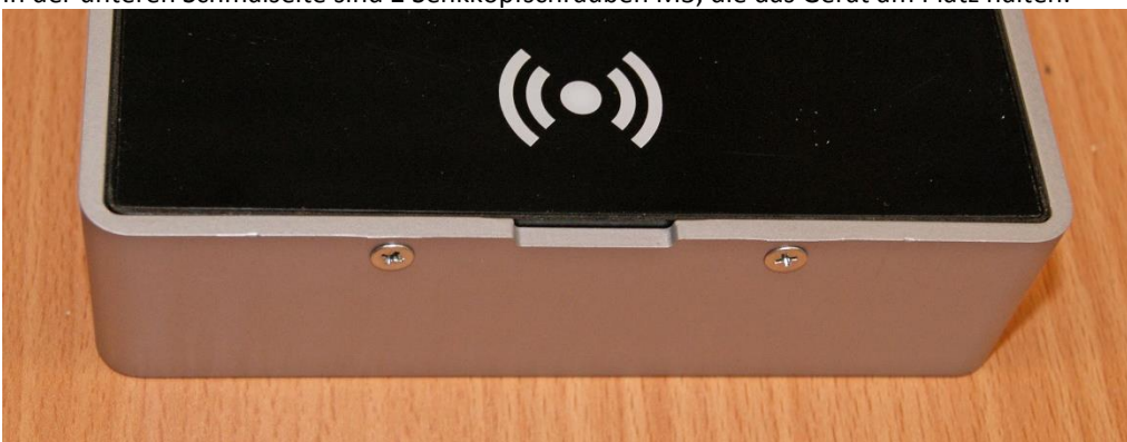
Abbildung 8: Gerätehalterung unten im Einbaurahmen
