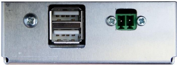
Abbildung 3: 2 x USB-A-Buchsen, 1 x Relaiskontakt (Schließer)
