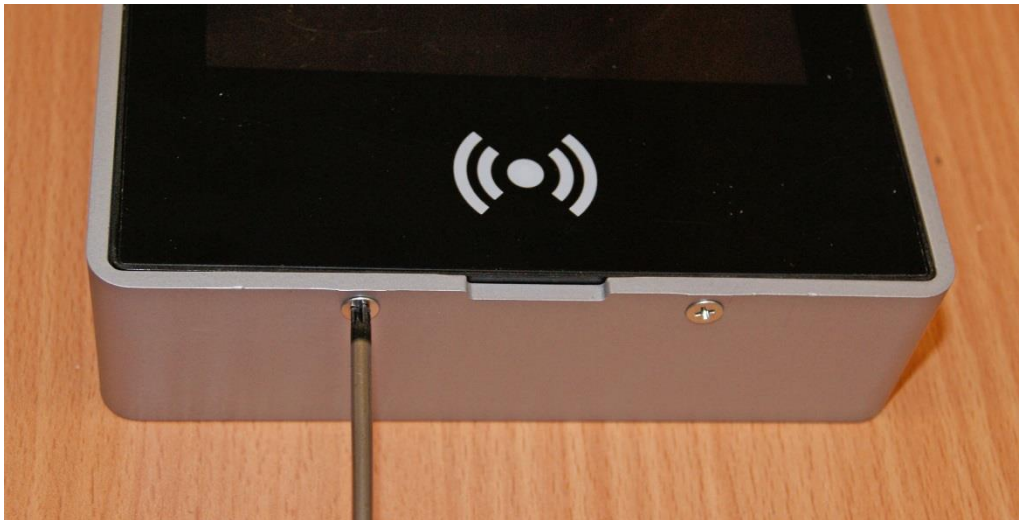
Abbildung 9: Entfernen der Schraube unten im Einbaurahmen
